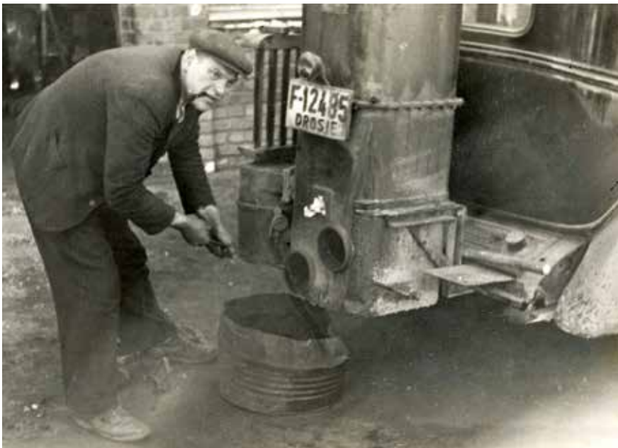
Drosjeeier Anton Torp i Hønefoss gjør ren knottegeneratoren på sin Buick.
